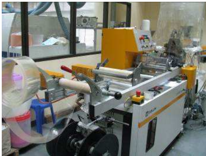
ภาพที่ 10 เครื่องผลิตฟิล์มพลาสติกแบบรีด
