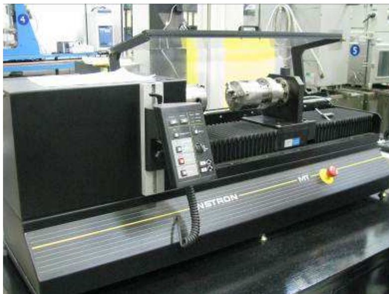
ภาพที่ 5 เครื่องทดสอบความทนทานต่อการบิด
